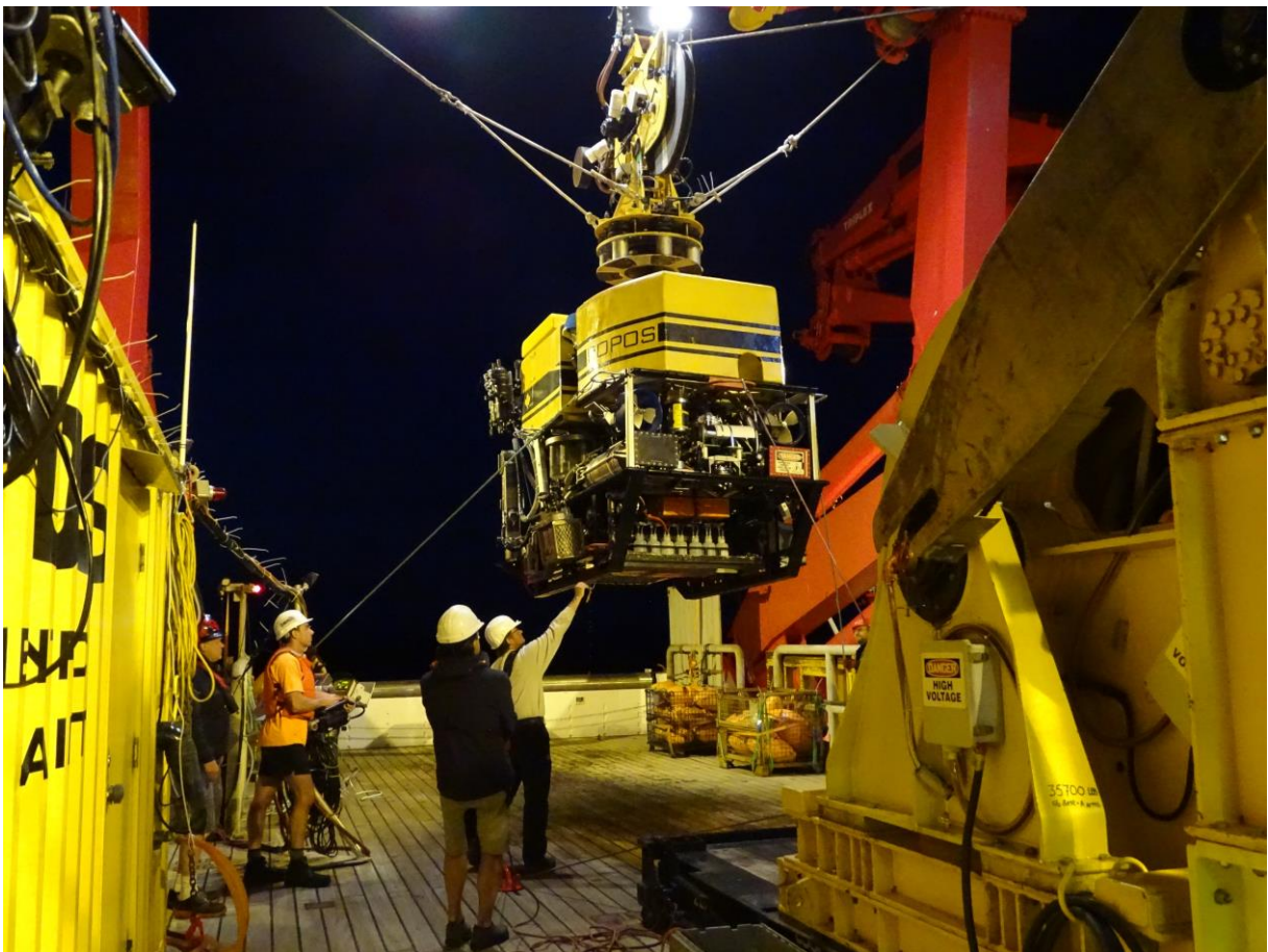
Die Bergung von ROPOS nach einem Tauchgang im KAIMANA Sulfidgebiet in Lizenzcluster #05.
