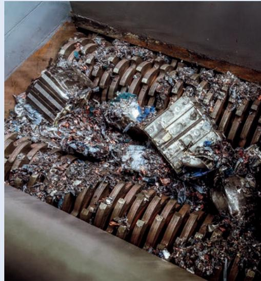
**Mechanische Aufbereitung von Lithium-Ionen-Batterien zur Herstellung pulverförmiger Schwarzmasse (mit frdl. Genehmigung der Fa. Duesenfeld GmbH).**
