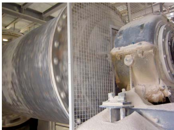
Aufmahlung vorzerkleinerten Rhyoliths zum Feldspatprodukt, hier bei der Saarfeldspatwerke H. Huppert GmbH & Co. KG im Werk Güdesweiler, Foto: BGR.
