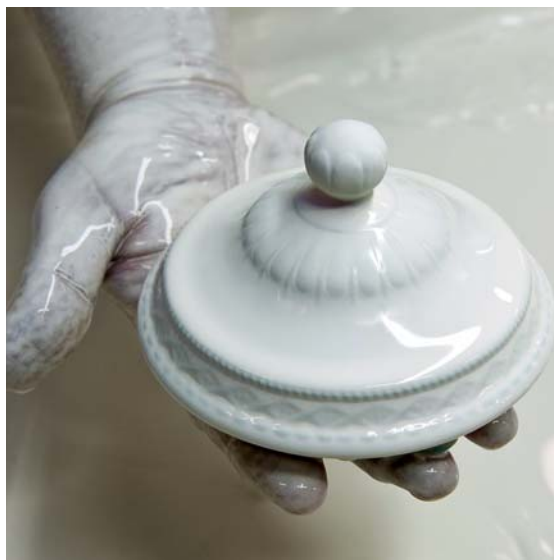
Glasuren enthalten bis zu 36 % Kalifeldspat, Foto: Königliche Porzellan-Manufaktur Berlin (mit frdl. Genehmigung).
