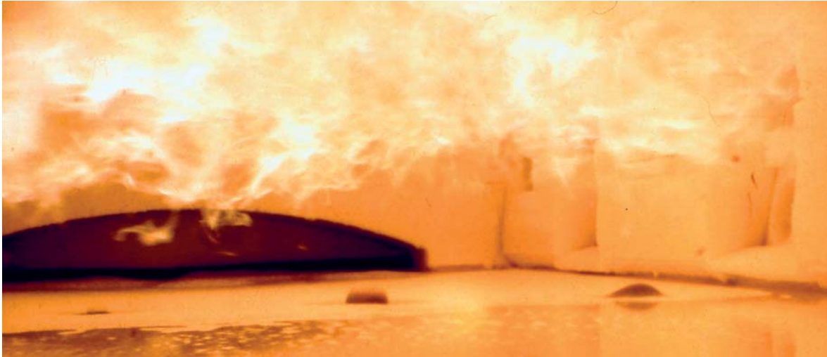
Foto aus dem Inneren einer Glasschmelzwanne, wo oft Temperaturen bis 1.600 °C herrschen, Foto: Hüttentechnische Vereinigung der Deutschen Glasindustrie (HVG) e.V. (mit frdl. Genehmigung).
