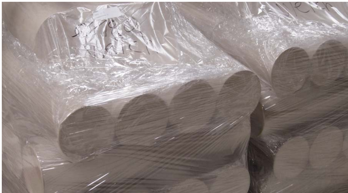
Hubel sind keramische Massen (hier im Werk Schmelitz der Imerys Tableware Deutschland GmbH) zur Produktion von gedrehter Keramik, z. B. Vasen, Foto: BGR.
