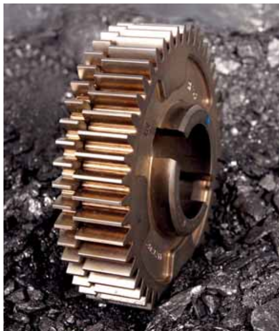
Selbstschmierende Zahnräder werden aus Graphit und einem Metallpulver gepresst, Foto: Graphit Kropfmühl GmbH.
