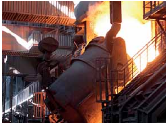
Zur Stahlherstellung wird neben Roheisen auch Kalk zur Bindung bzw. Entfernung störender Elemente eingesetzt, Foto: Salzgitter AG.
