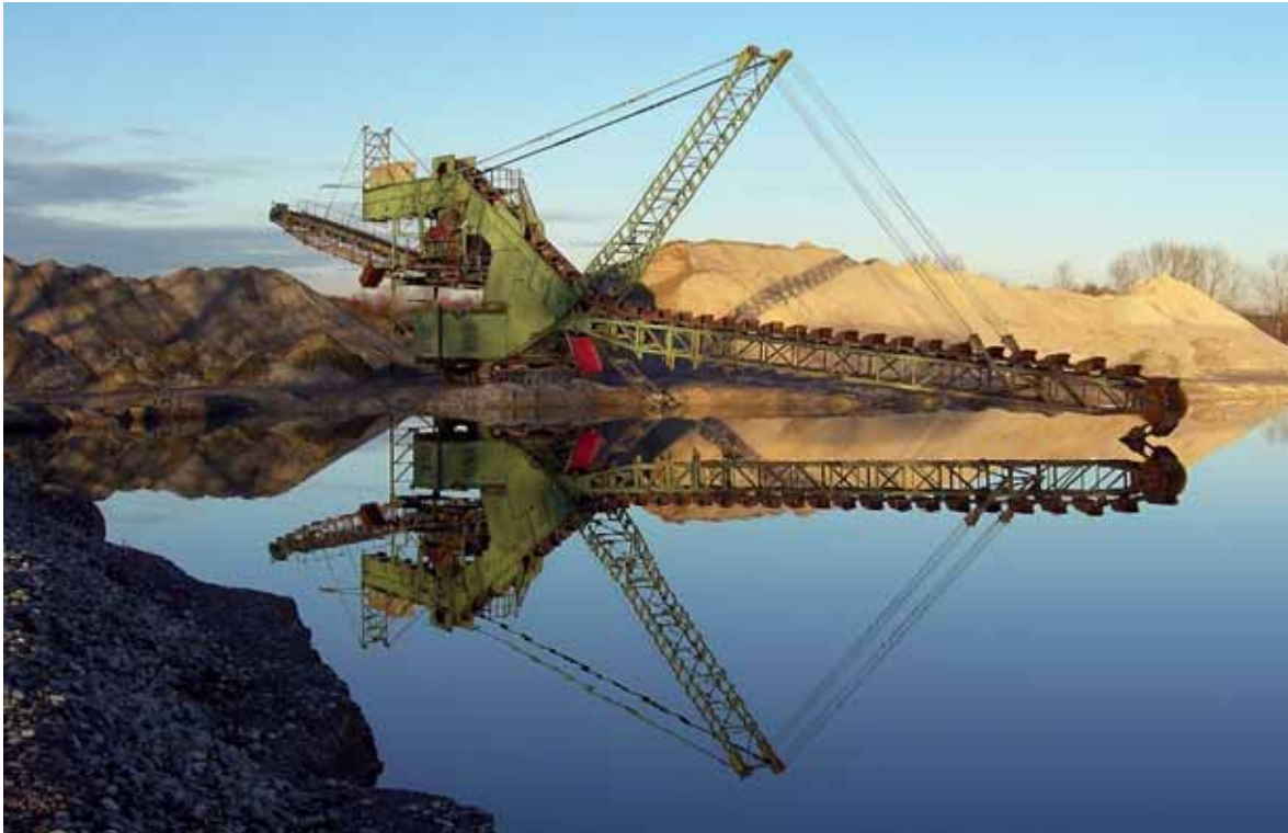
Im oberbayerischen Kieswerk Niederneuching der Ebenhöf GmbH & Co. Kies- und Sandwerke KG werden mittels mobilem Eimerkettenbagger hochwertige Kiessande zur Versorgung des Raums Erding gewonnen, Foto: MIRO/Poschlod.
