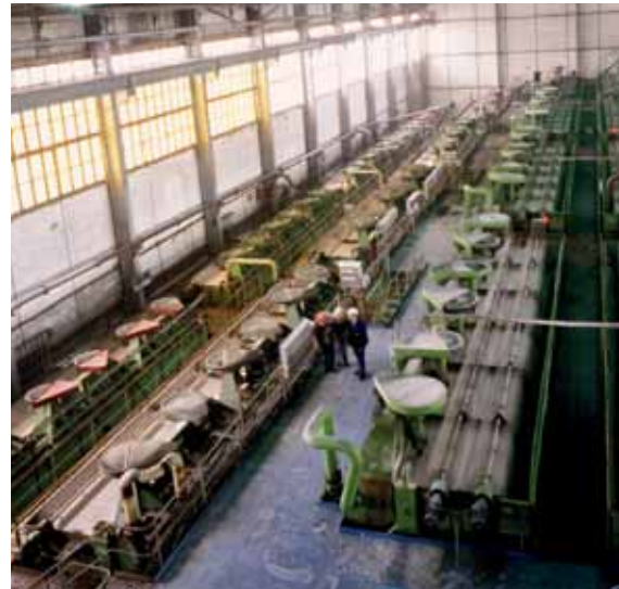
Aufbereitung von Kalisalzen durch Flotation im Kaliwerk Zielitz, Foto: K+S AG (mit frdl. Genehmigung).
