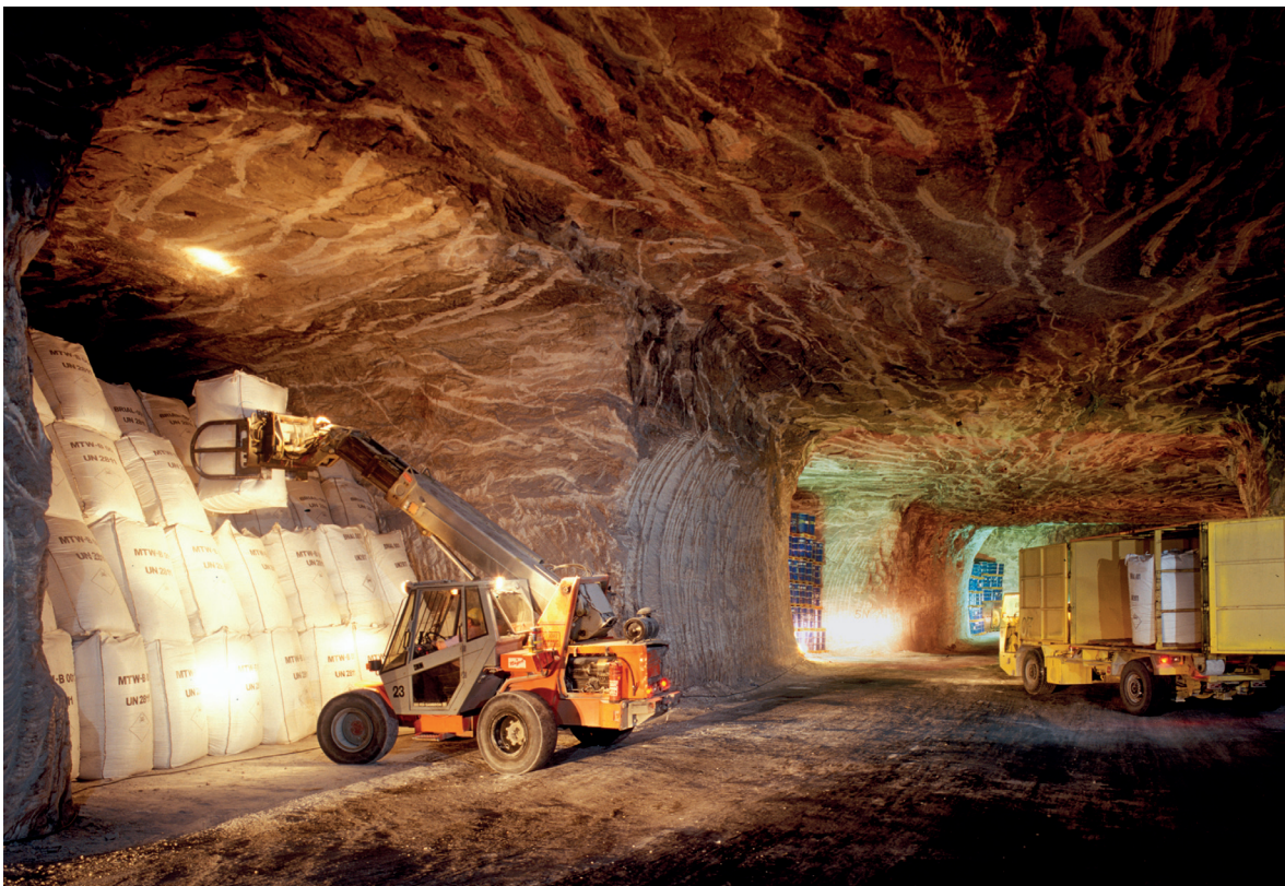
Deponierung von stark belasteten Abfällen in einem bereits abgebauten Teilbereich des Salzbergwerks Zielitz in Sachsen-Anhalt, Foto: K+S Entsorgung GmbH (mit frdl. Genehmigung).
