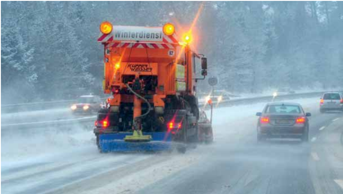
In modernen Streufahrzeugen kommen ergänzend Auftausalz und Sole zum Einsatz, Foto: K+S AG (mit frdl. Genehmigung).
