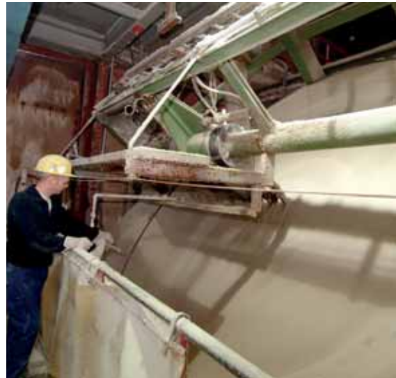
Um ein definiertes Kornspektrum zu erzeugen, werden Düngemittel granuliert, so dass sie durch Kreiseltreuer besonders effizient ausgebracht werden können, Foto: K+S AG (mit frdl. Genehmigung).
