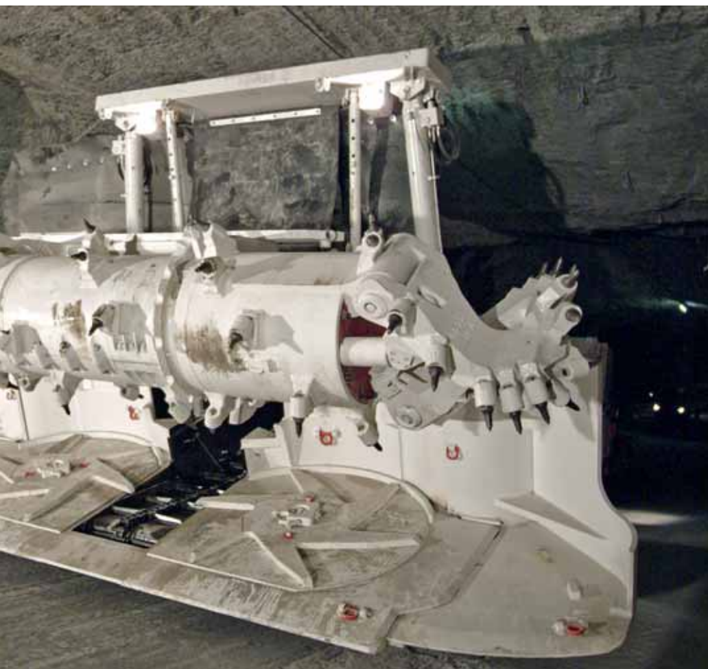
Diese riesige Salzfräse schneidet Steinsalz aus dem bis 20 m mächtigen Steinsalzlager im Bergwerk Heilbronn, Foto: Südwestdeutsche Salzwerke AG (mit frdl. Genehmigung).
