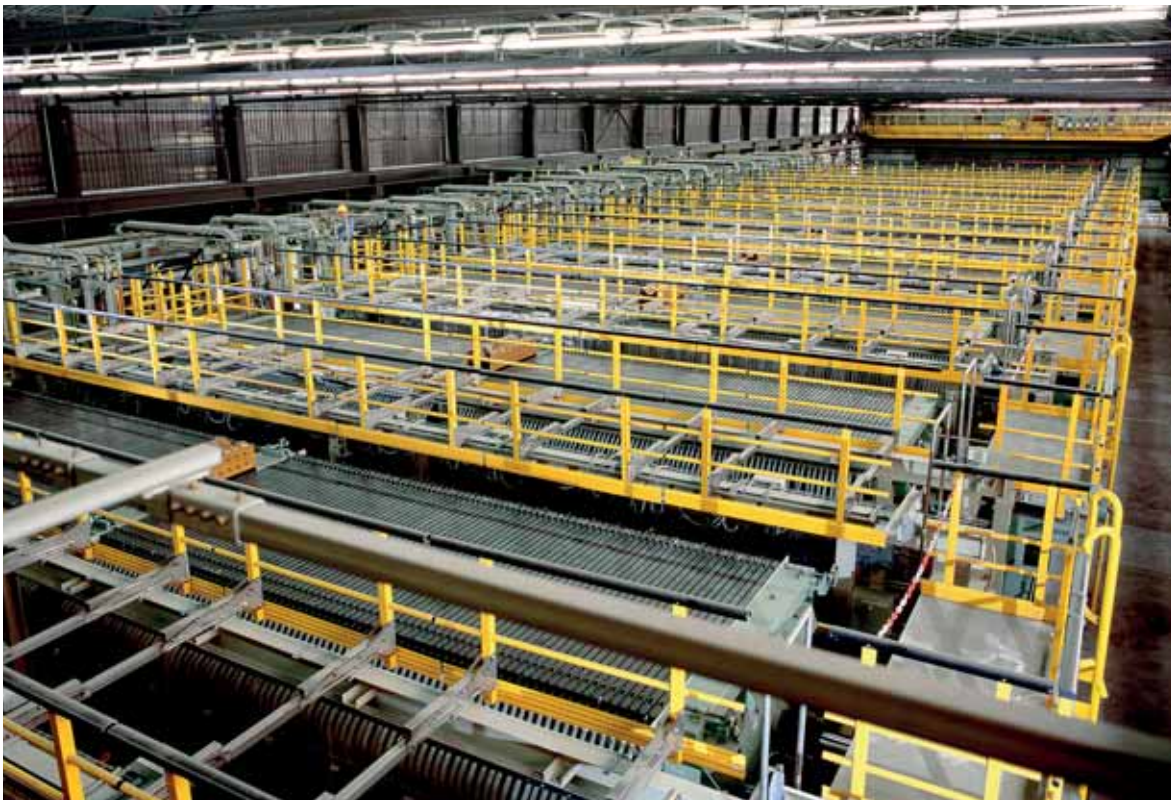
Am Standort Ludwigshafen betreibt die BASF eine hochmoderne Chloralkali-Elektrolyse nach dem Membranverfahren. Dabei entstehen die Grundstoffe Chlor und hochreine Natronlauge sowie Wasserstoff als Nebenprodukt, Foto: BASF SE (mit frdl. Genehmigung).
