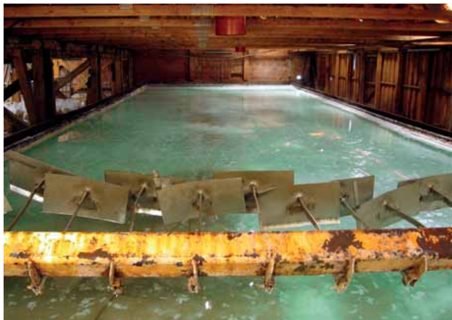
In der Saline Luisenhall wird das Salz mittels halbautomatischen Rechen aus der Siedepfanne abgezogen, Foto: Andreas Trepte, www.photo-natur.de, (mit frdl. Genehmigung).
