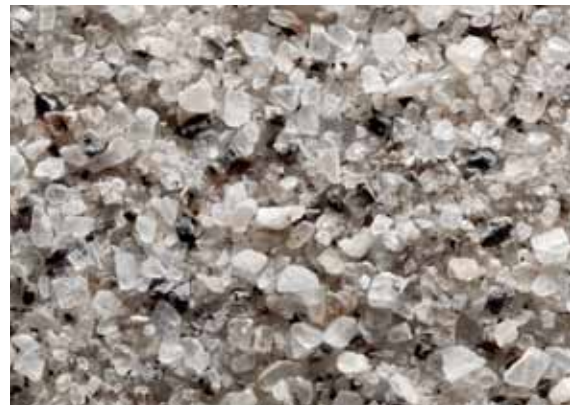
Steinsalz aus ihrem Steinsalzbergwerk Stetten in Baden-Württemberg dient der Wacker Chemie AG zur Produktion von Reinstsilizium (Halbleitersilizium, Solarzellensilizium) in ihrem Werk Burghausen, Foto: Wacker Chemie AG (mit frdl. Genehmigung).
