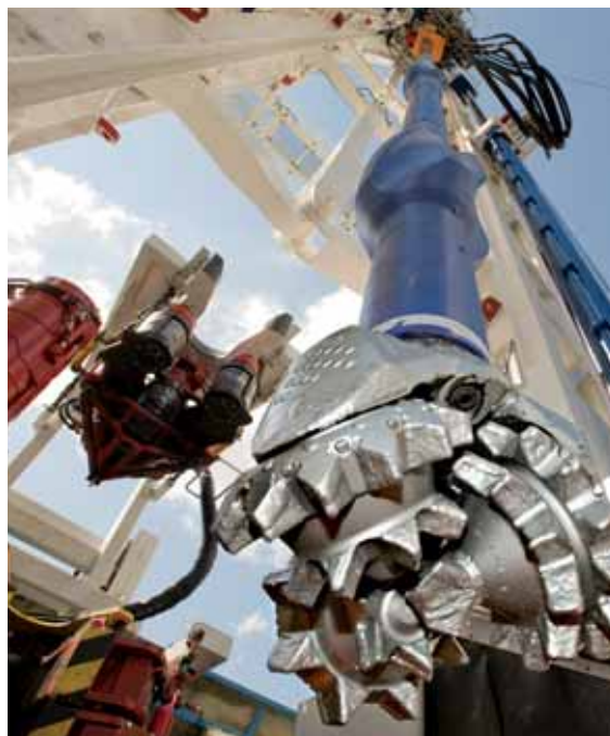
Bohrmeißel an Bohrköpfen müssen beim Bohren durch salzhaltige Bohrspüllösungen gekühlt und geschmiert werden, Foto: BGR.
