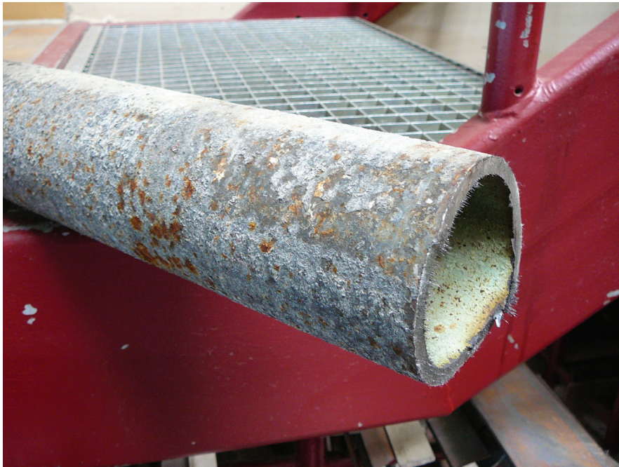
Abb. 4.2.14: Rohrstück von unterhalb des Packers vorm Aufschneiden und Auskratzen
