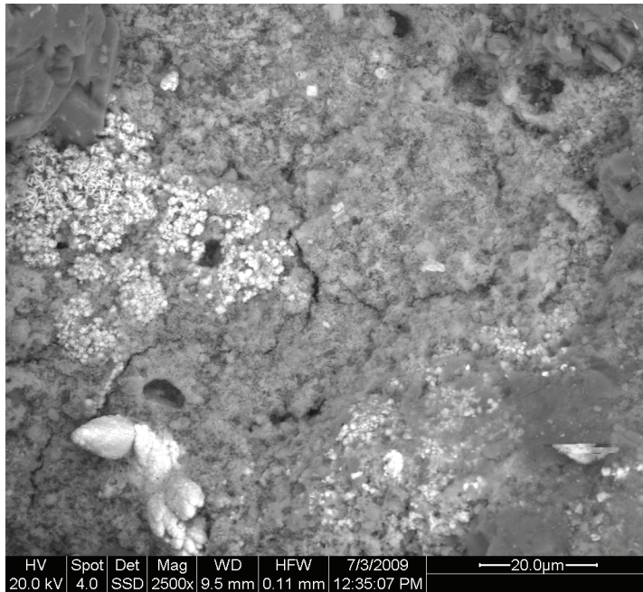
Abb. 4.2.19: REM-Aufnahme einer Probe von unterhalb des Packers; Scaling bei 2.500-facher Vergrößerung; Ei-förmige Minerale in der linken unteren Bildecke: Pb-haltige Phase; helle Minerale links oben: Kupferarsenid; kristalline Phase links oben: Calcit; restliche Oberfläche Eisenoxid
