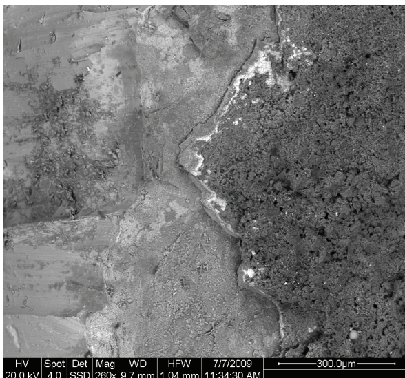
Abb. 4.2.22: REM-Aufnahme einer Probe von unterhalb des Packers; Probe um 45° gekippt; Darstellung der Probenkante mit Scaling bei 260-facher Vergrößerung; helle Phase am linken Rand: Stahl mit Bearbeitungsriefen (Sägen der Probe) z. T. oxidiert; helle Phase in der Ablagerung: Kupferarsenid; dunkle Phase auf der rechten Seite des Bildes: Calcit;
