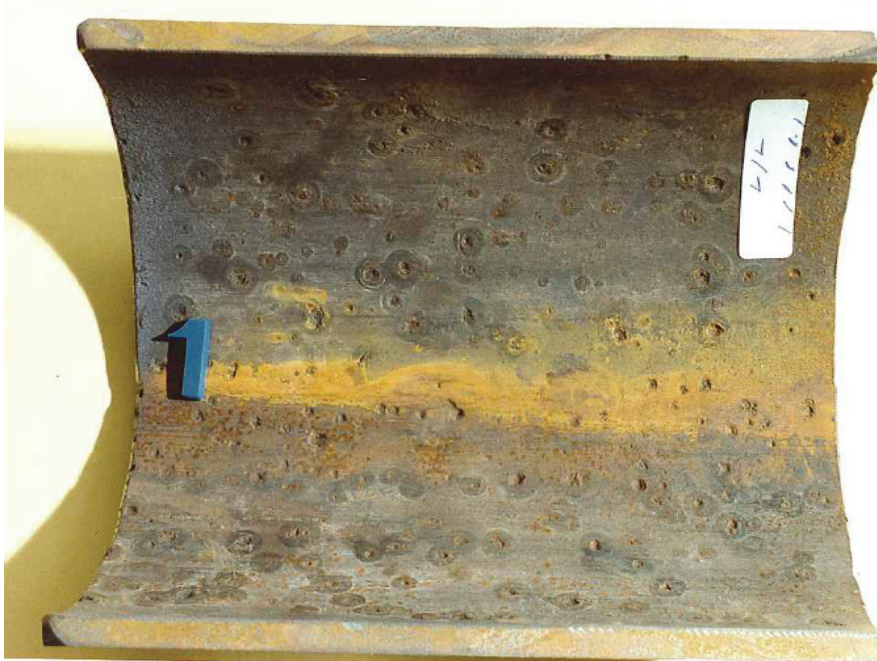
Abb. 4.2.23: Aufgeschnittenes Rohrgestänge aus der KTB; mulden- bis lochförmige Korrosionsschäden; Ursache: Belüftungselement durch Anhaften von Spülungsresten (aus: Luis et al., 1989; unveröffentlichter Bericht)
