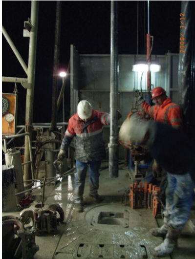
Abb. 3.6: Ausbau des gefangenen „Fisches (Packer)“ - oberer Teil
