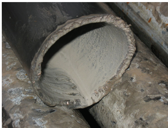
Abb. 3.3: Explosiv getrennter Strang aus ca. 3750 m Tiefe
