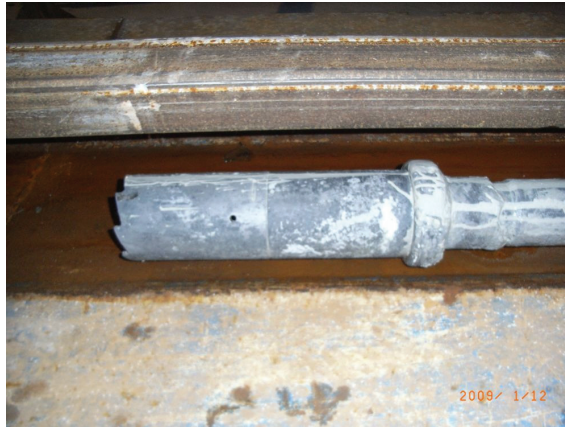
Abb. 3.6: Ausbau des gefangenen „Fisches (Packer)“ - oberer Teil
