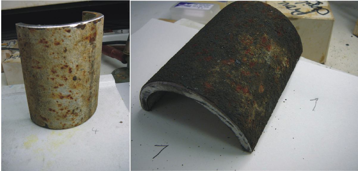
Abb. 4.2.2: Schäden und Ablagerungen an der Außenwand eines Rohrstücks von unterhalb des Packers
