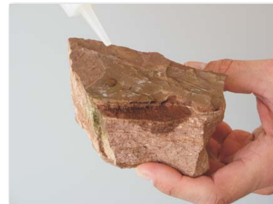
Speicher- und Barrieregestein in einem Handstück: Sandstein (unten) saugt den Wassertropfen auf, Tonstein (oben) lässt ihn nicht durch.
