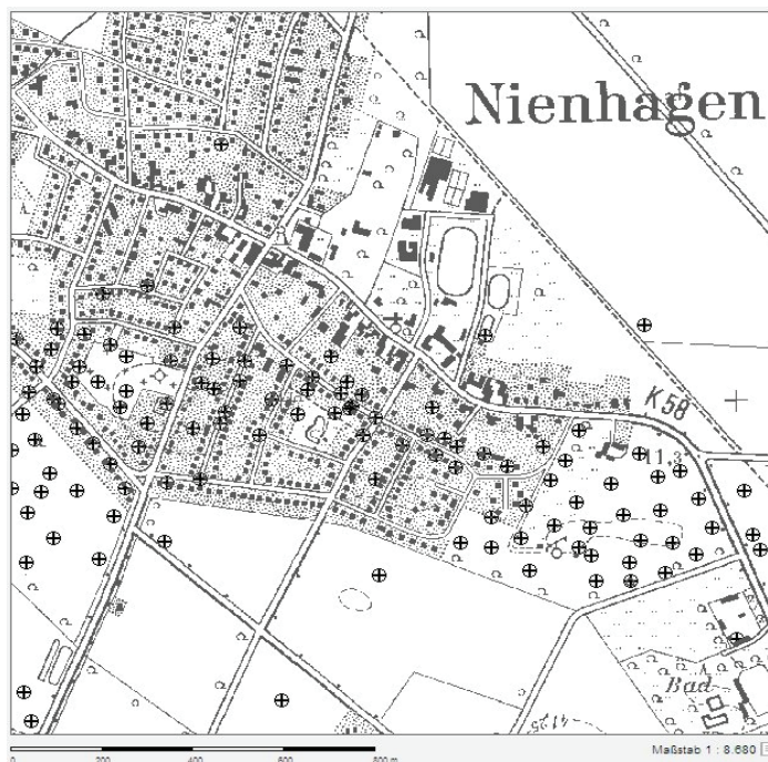
Abb. 3.1: Altbohrungen in einer neuen Einfamilienhaussiedlung in Nienhagen bei Celle. Die Straßenführung folgt hier vermutlich dem Verlauf der alten Feldbahnen, so dass die verfüllten Bohrungen in den Privatgrundstücken stehen (pers. Mitt. A. BARTECZKO 2009). Quelle: LBEG, Hannover, cardo.map
