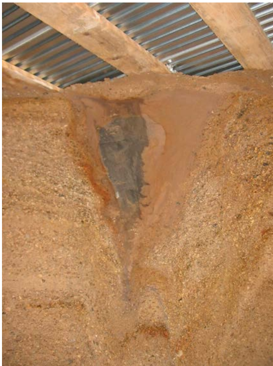
Abb. 9.282.: Baugrubenaufschluß eines Eiskeiles in der Joachimstr., ca. 2.5 m tief, nördlich angrenzend des Projektgebietes mit feinkörniger Füllung; Quelle: M. Wieschemeyer & M. Wegner, M & P.
