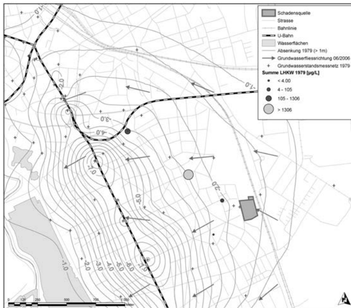
Abb. 9.109.: Interpolierter Grundwasserdifferenzenplan Juni/Juli 1979. Im Zuge der Bauarbeiten an der U-Bahnlinie B—Süd wurde eine großräumige Absenkung an der Hildesheimer Strasse vorgenommen, die Absenkbeträge betragen z.T. über 7 m. In 1979 wurden relativ wenige LHKW-Analysen vorgenommen, die Messstelle an der Nazarethkirche (Trinkwassernotbrunnen 150131) zeigt wiederum ein Maximum.
