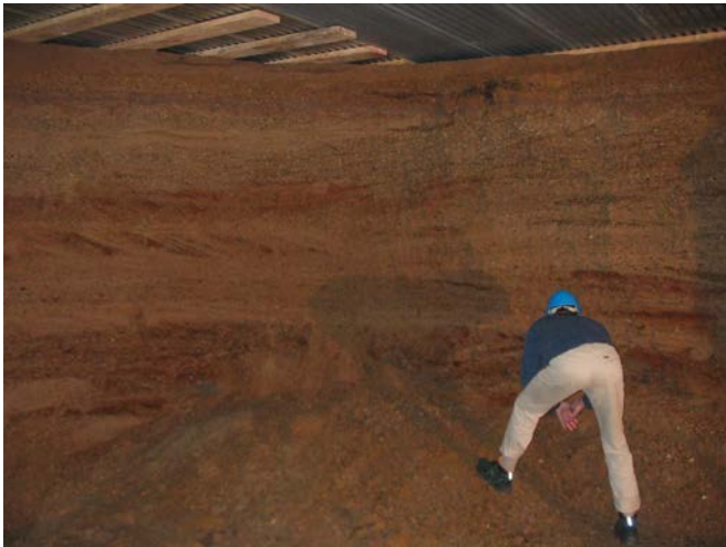
Abb. 9.21.: Wand eines Baugrubenaufschlusses in der Joachimstr. am nördlichen Rand des Projektgebietes. Glaziofluviale Genese: ausgeprägte Schrägschichtung, Tongerölle, geringmächtige Schluffschichten und strukturabhängige Eisenoxyhydroxidkrusten lassen erkennen, dass die Annahme eines homogenen, hydraulisch isotropen Grundwasserleiters eine starke Vereinfachung darstellt. Quelle: M. Wieschemeyer & M. Wegner, M & P.
