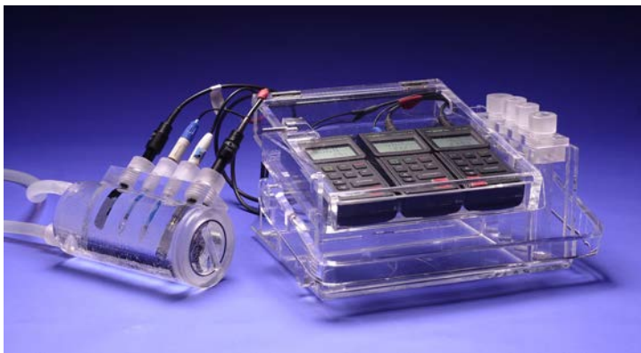
Abb. 9.23.: Durchflußmesszelle, Messgerätekoffer für 3 gebräuchliche Handmessgeräte und integrierter Aufbewahrung für Elektroden, Material Plexiglas; Entwurf Rausch/BGR.
