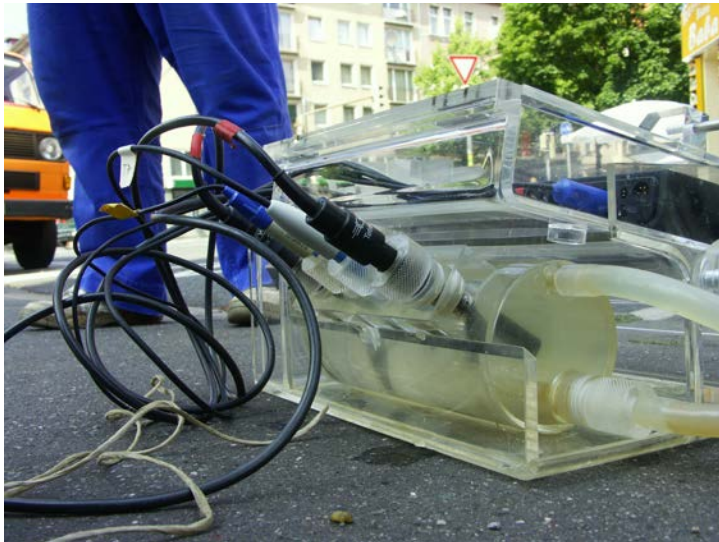
Abb. 9.24.: Bestimmung der physikalisch-chemischen Feldparameter in der Durchflussmesszelle während des Abpumpvorganges. Eine Trübung der Probe ist noch deutlich vorhanden, eine leichte Ausgasung ist erkennbar.
