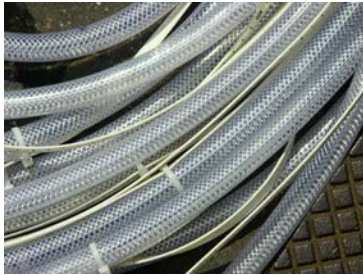
Abb. 9.22.: PVC-Gewebeschläuche mit Kabelbinder mit einem Metermaß verbunden wurden in Hannover-Südstadt für die Monitoringkampagnen eingesetzt. Um eine Verschleppung von Chlorethenen auszuschliessen, wurden wöchentlich im Labor sog. „Nullproben“ gewonnen und analysiert. Trichlorethen-Verschleppung wurde durch die Beprobungsreihenfolge ausgeschlossen.
