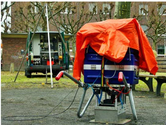
Abb. 9.57.: VSP-Messung am Bohrloch. Vorn: Scherwellenquelle. Mitte: Dreibein mit eingehängter VSP-Sonde im offenen Bohrloch. Schräg links vor dem Bohrloch befindet sich das Referenzgeophon (gelb). Hinten: geöffnetes Bohrlochmessfahrzeug.
