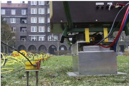
Abb. 9.34.: Profilanlage auf dem Geibelplatz, Hannover-Südstadt, am 9.2.2005 mit Blickrichtung nach Nordwest. Links unten ist die Aufreihung der seismischen Horizontalempfänger zu erkennen, rechts die Anregungseinheit der vibrationsseismischen Scherwellenquelle.
