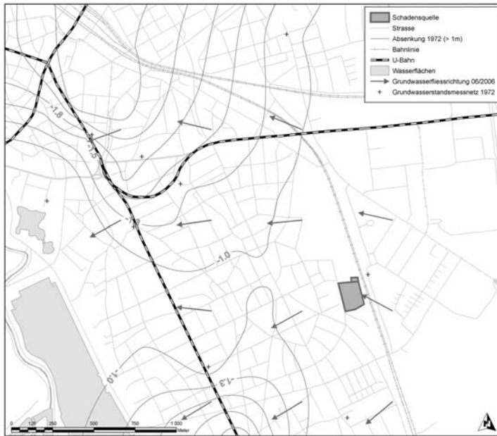
Abb. 9.107.: Interpolierter Grundwasserdifferenzenplan Juni/Juli 1972. Im Nordwesten sind die Auswirkungen der Grundwasserabsenkung im Zuge des U-Bahn-Knotenpunktes Kröpcke zu erkennen. Der südliche Absenktrichter rührt von einer langjährigen Brauchwasserentnahme her. Zum Vergleich ist als Pfeilschwarm die unbeeinflusste Grundwasserfließrichtung vom Juni 2006 dargestellt.
