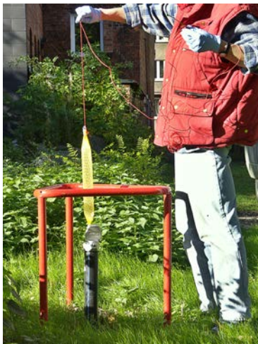
Abb. 9.123.: Einbau eines Passivsammlers (Messstelle: 180928)
