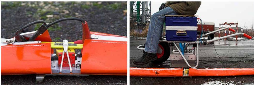
Abb. 9.54.: Geophonstation und Scherwellenquelle. Links: Konfiguration einer einzelnen Geophonstation. Rechts: mobile Scherwellenquelle und Teil des Land Streamer
