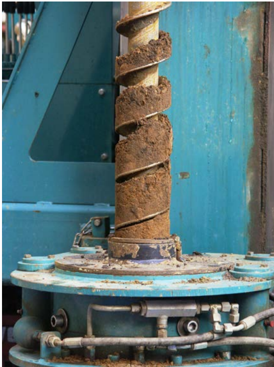
Abb. 9.8.: Bohrung mit Endlosschnecke Drehtisch mit gezogener Schnecke. Das geförder- te Sediment liegt auf der Schneide auf.
