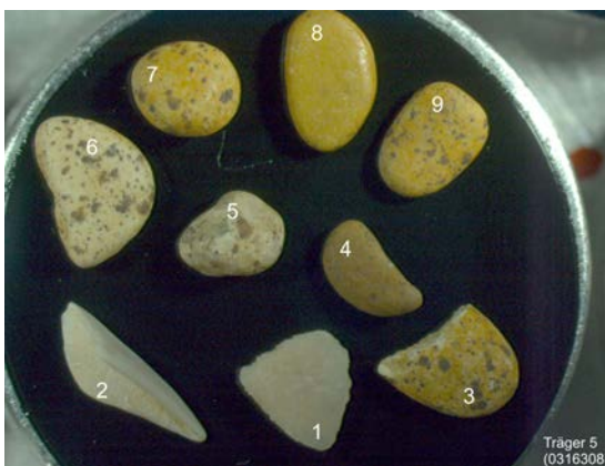
Abb. 9.93.: Tonsteinpartikel (3 – 9) mit Überzügen aus \text{Fe(III)} oxyhydroxiden und Kalkstein (1, 2) aus Probe 316308 7.85 m u. GOK, Bohrung Gr. Barlinge.
