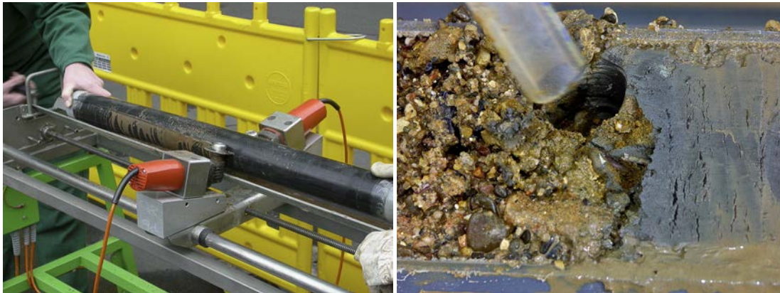
Abb. 9.11.: Links: Kernschneidetisch. Ein PVC-Liner wird durch oszillierende Schneidblätter aufgetrennt. Rechts: Probenentnahme mittels Einwegspritze. Am Übergang Kies/Ton wird eine Probe mittels Kunststoffeinwegspritze (oben) entnommen
