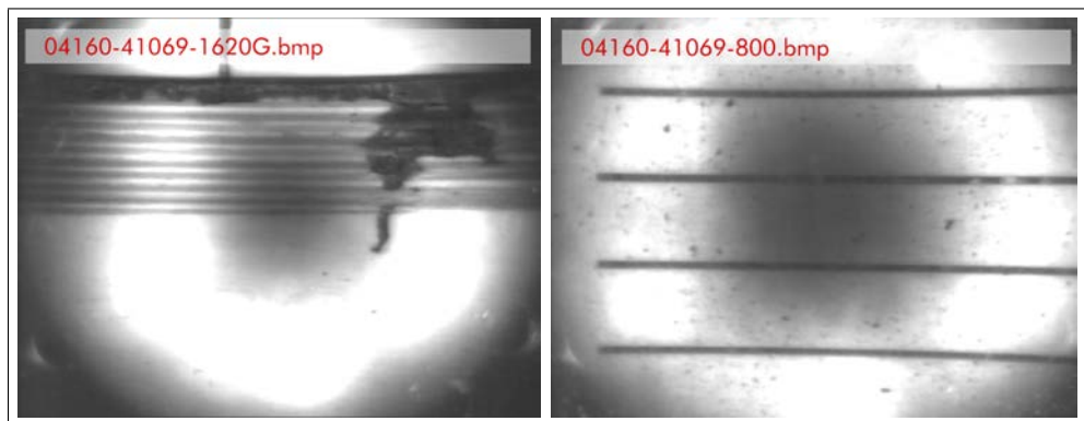
Abb. 9.18.: Beispiele der Photodokumentation des GFV-Verfahrens (Messstelle 41069). Links: Verschraubung eines Vollrohrübergangs (PVC-Rohr, DN100). Rechts: Filterschlitzöffnung
