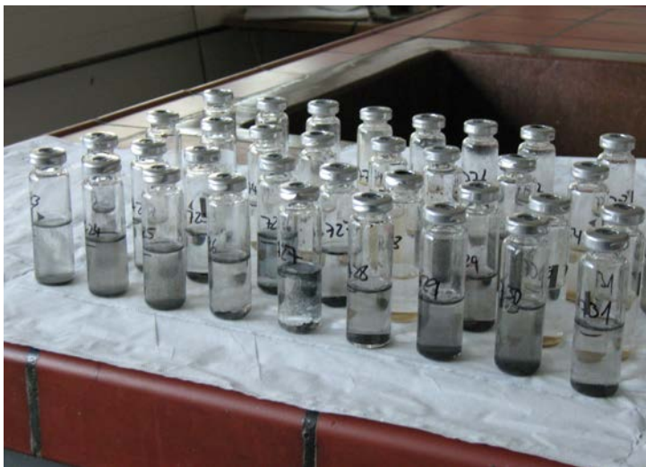
Abb. 9.245.: "Zufalls"-Mikrokosmen als Nachweis mikrobieller Sulfatreduktion im Rinnenbereich des Grundwasserleiters (DP-Proben); Bodensatz aus Suspension in den Headspacefläschchen braun: (unverändert) vs. schwarz: starke FeS-Entstehung.
