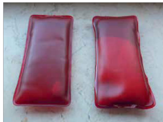
Abb. 4.71: Latentwärmespeicher für Handwärmekissen, links: vollständig flüssig, rechts: Kristallisation unter Wärmeabgabe (Quelle: FRAUNHOFER ISI)
