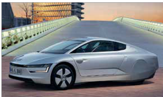
Abb. 4.116: Volkswagen XL1 mit CFK-Monocoque (Quelle: VOLKSWAGEN AG)
