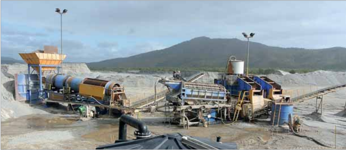
Abb. 2.26.3: Aufbereitung der Abgänge (Tailings) von Mount Carbine (Foto: BGR).
