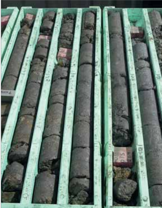
Abb. 2.11.2: Bohrkerne mit verwitterten, sehr stark vererzten Graphitschiefern der Graphitlagerstätte Uley (Foto: BGR).
