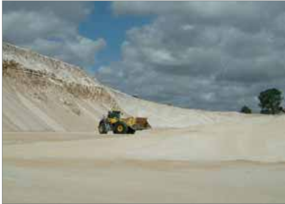
Abb. 2.20.8: Gewinnung von Quarzsand (hier als ungewaschener Betonsand) aus einem Teil des Quarzsandabbaus Gngangara bei Lexia, Western Australia (Foto: BGR).
