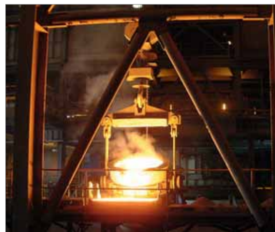
Abb. 2.20.9: Guss von Siliziummetall in der Siliziumhütte von SIMCOA in Kemerton, Western Australia (Foto: BGR).
