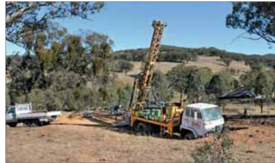
Abb. 2.5.7: Explorationsbohrung auf der Lagerstätte Kempfield (Wiedergabe mit freundlicher Genehmigung von Argent Minerals Ltd.).
