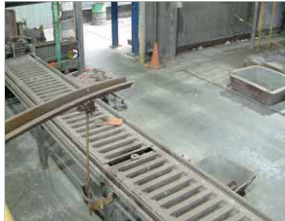
Abb. 2.27.2: Möglichkeit zum Guss von Zinnbarren in der Zinnhütte von Greenbushes (Foto: BGR).
