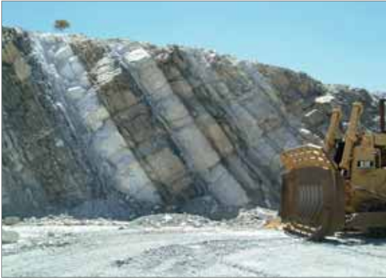
Abb. 2.16.6: Gewinnung steil einfallender Magnesitbänke im Myrtle Springs Tagebau nordwestlich Leigh Creek. In der Bildmitte die hellen Magnesitlagen 4 (rechts) und 5 (links) (Foto: BGR).
