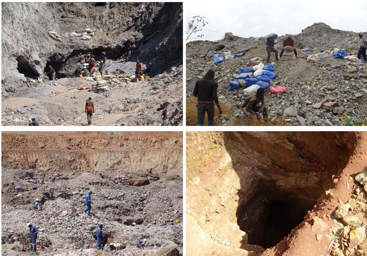
Figure 25 Photographies illustrant l'équipement et la protection inadéquats des exploitants artisanaux dans le secteur de l'exploitation minière artisanale. Le travail sur des pentes trop raides est une pratique courante (en haut à gauche), le soulèvement de charges lourdes est effectué par un seul homme ou un seul enfant (en haut à droite). Le port d'équipement de protection individuelle est l'exception (en bas à gauche), les ouvertures de tunnel ou les puits ne sont pas sécurisés (en bas à droite).
