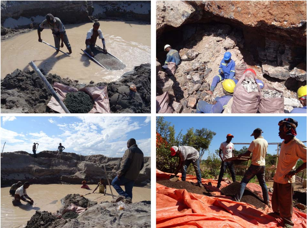
Figure 13 Les techniques de traitement du minerai de cuivre et de cobalt dans l'artisanat minier congolais. Ci-dessus sont illustrées les étapes de lavage, de concassage et de tamisage du minerai.
