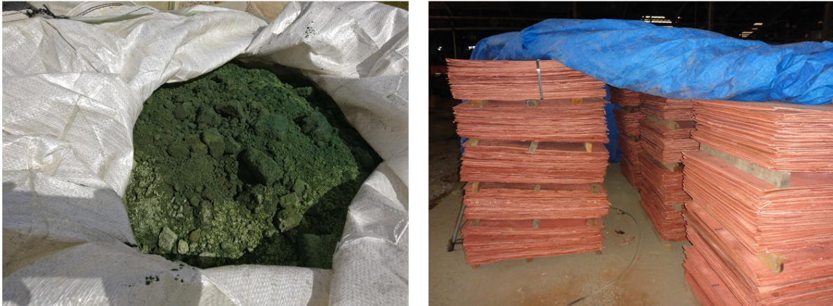
Figure 18 Produits finaux de la chaîne de valeur et d'approvisionnement intra-congolaise. Hydroxyde de cobalt à gauche, cathodes de cuivre à droite. Ces produits sont fabriqués à l'aide de procédés hydro-métallurgiques gourmands en énergie, nécessitant l'utilisation de produits chimiques et un savoir-faire technique.
