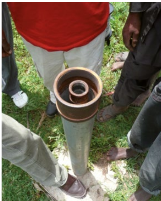
Figure 5.3 Un exemple d'ouvrage de suivi : un tubage crépiné de 1'' ou 2'' avec un tubage supérieur de 3 ou 4'' qui protège l'ouvrage des inondations et permet de visser un bouchon de protection approprié. Les piézomètres d'observation de 1'' sont faits pour les mesures de niveau de l'eau uniquement (avec une sonde d'eau ou un capteur). Ceux de 2'' permettent également l'échantillonnage de l'eau avec un tube de prélèvement.
