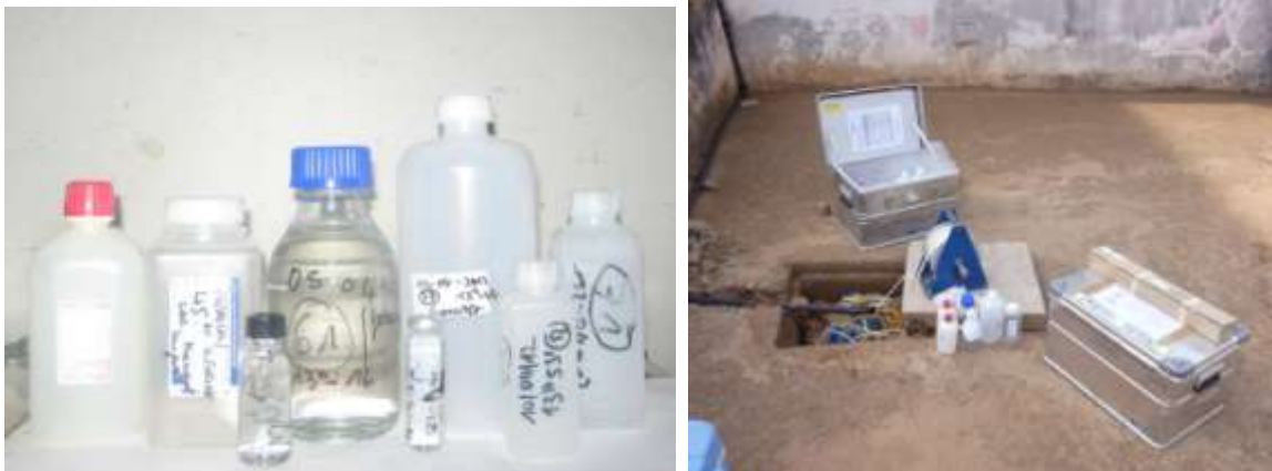
Figure 12: (à gauche) Un jeu de bouteilles utilisées pour les analyses microbiologiques, chimiques minérales et chimiques organiques ; (à droite) Jeu de bouteilles pleines après échantillonnage d'un puits privé équipé d'une pompe submersible (forage) - (left) Bottle-set used for microbiological, inorganic chemical and organic chemical analysis; (right) Full bottle-set after sampling a private well equipped with a submersible pump (forage).
