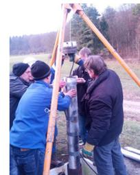
Einbau eines Bohrlochseismometers an einer Messstation in der Fränkischen Schweiz.
